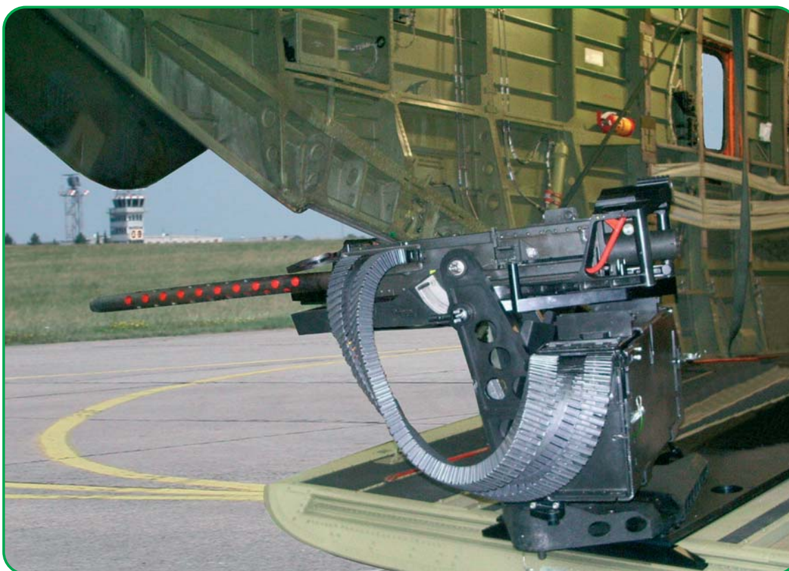
Die zusätzliche Station auf der Heckrampe, soll einen vollständigen Rundum-Schutz gewährleisten. Quelle: Bundeswehr
