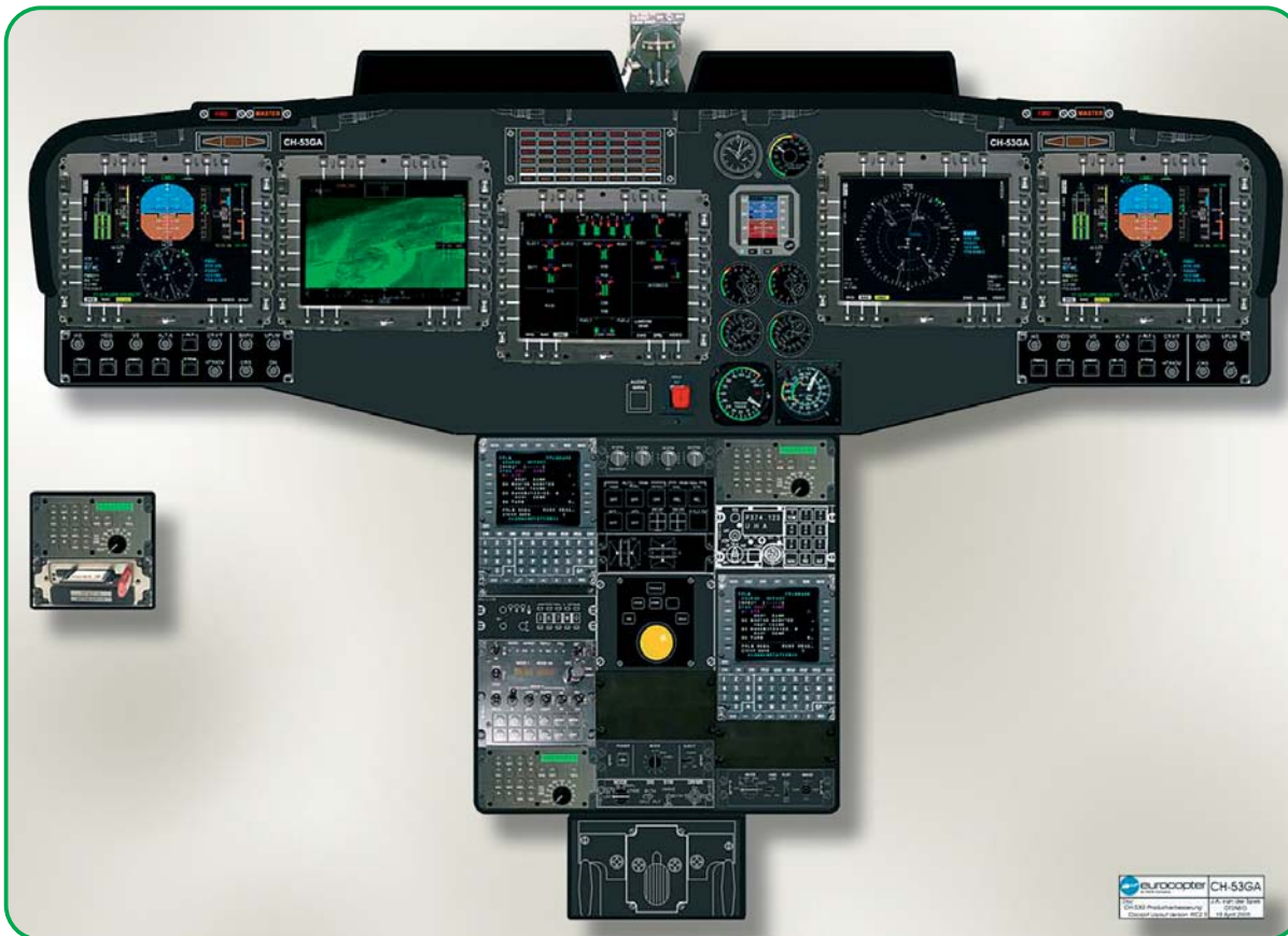
Das neue Erscheinungsbild des angepassten Cockpits mit 5 Multi-Funktions-Displays und 2 zentralen Bediengeräten ("Glascockpit"). Quelle: Bundeswehr
