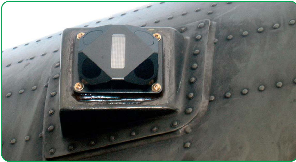
Der neue Sensor Laserwarner LWS 20 V3 kann ohne Veränderung der Integration im Luftfahrzeug eingebaut werden, und hat im Feldversuch seine gute Leistungsfähigkeit unter Beweis gestellt. Quelle: Bundeswehr
